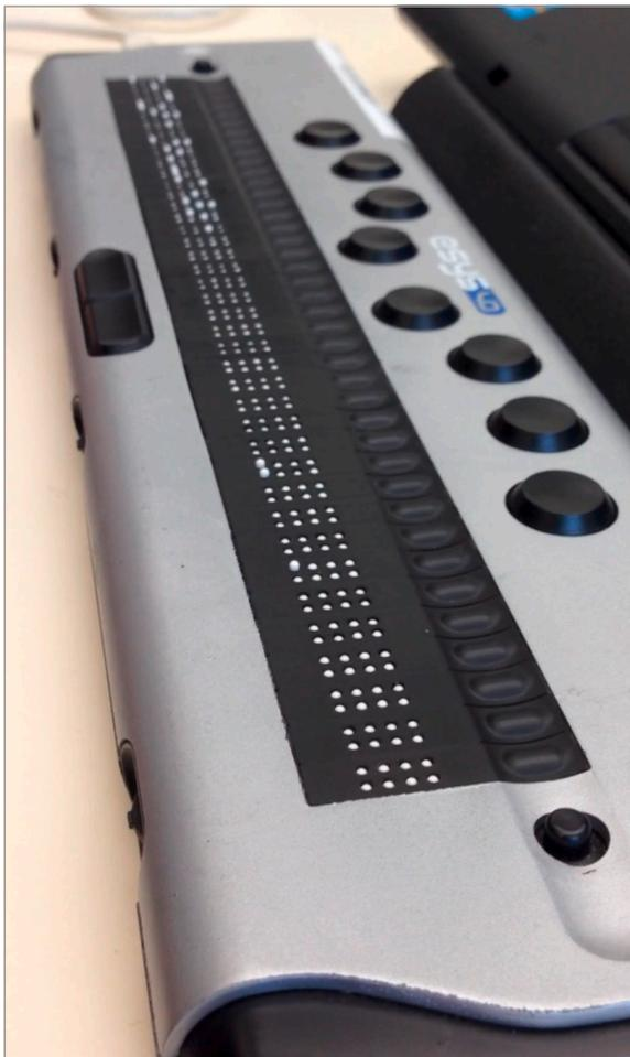
fig. 3 – Braillezeile, die via USB am Computer angeschlossen ist, mit Achtpunkt-Braille Buchstaben, 8-Punkt-Braille-Eingabe und Steuertasten
